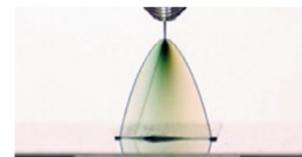
Abb. 2: Beschichtung mittels TwinJet-Verfahren. Eingefärbte Komponenten (blau und orange) dienen zur Beurteilung der Mischbarkeit.
