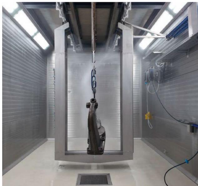
Die Werkstücke aus Aluminium werden im Waschautomat Prozesssicher gereinigt.
