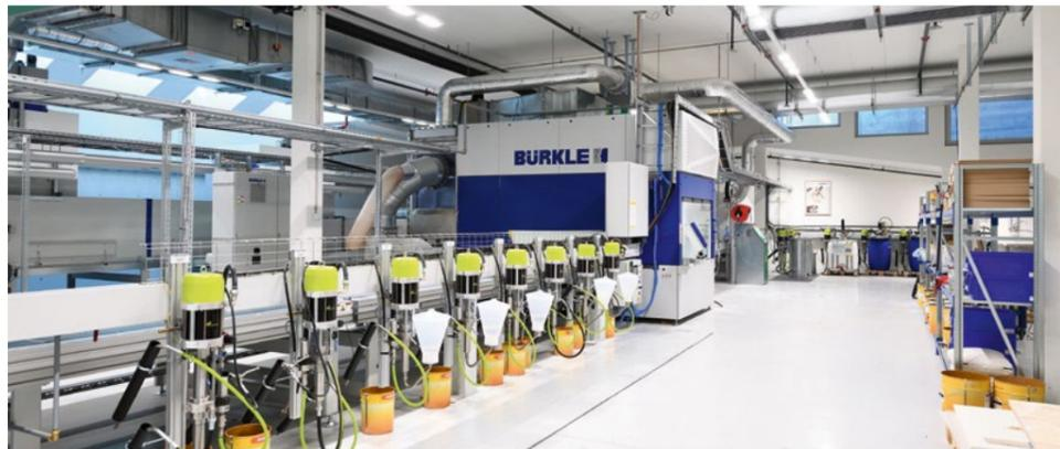
Die Holz-Innentüren werden auf der Spritzlackieranlage vollautomatisch beschichtet. Fotos: RIWAG Türen AG
