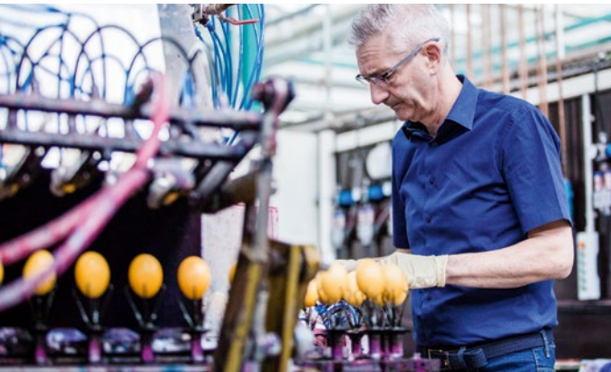
Bei der Spritzfärbemethode sitzen die Eier senkrecht auf kleinen Spindeln.
