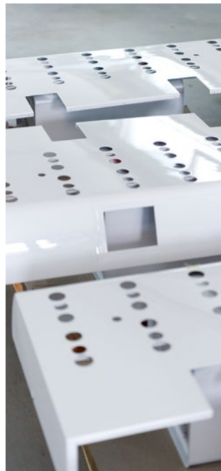
Der Betrieb bearbeitet Kleinserien, Prototypen und Produktmuster, aber auch Mittel- oder Großserien von Metall- und Kunststoffteilen, die von den Mitarbeitern überwiegend manuell lackiert werden.
