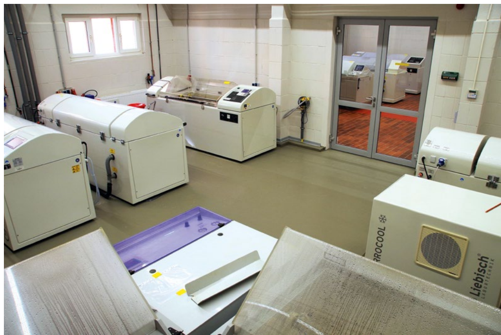
Der Prüfbereich Umweltsimulation ist nun u.a. mit Salzsprühnebelkammern, Kondenswasserschrank, Klimaschränken und Bewitterungsgeräten ausgestattet.
