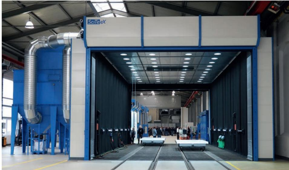
Die große Strahlanlage ist mit Schwerlast-Gitterrosten für 8 t Radbelastung ausgestattet. Die Schienenbreite ist so gewählt, dass auch in der Mitte ein Wagen fahren kann.
