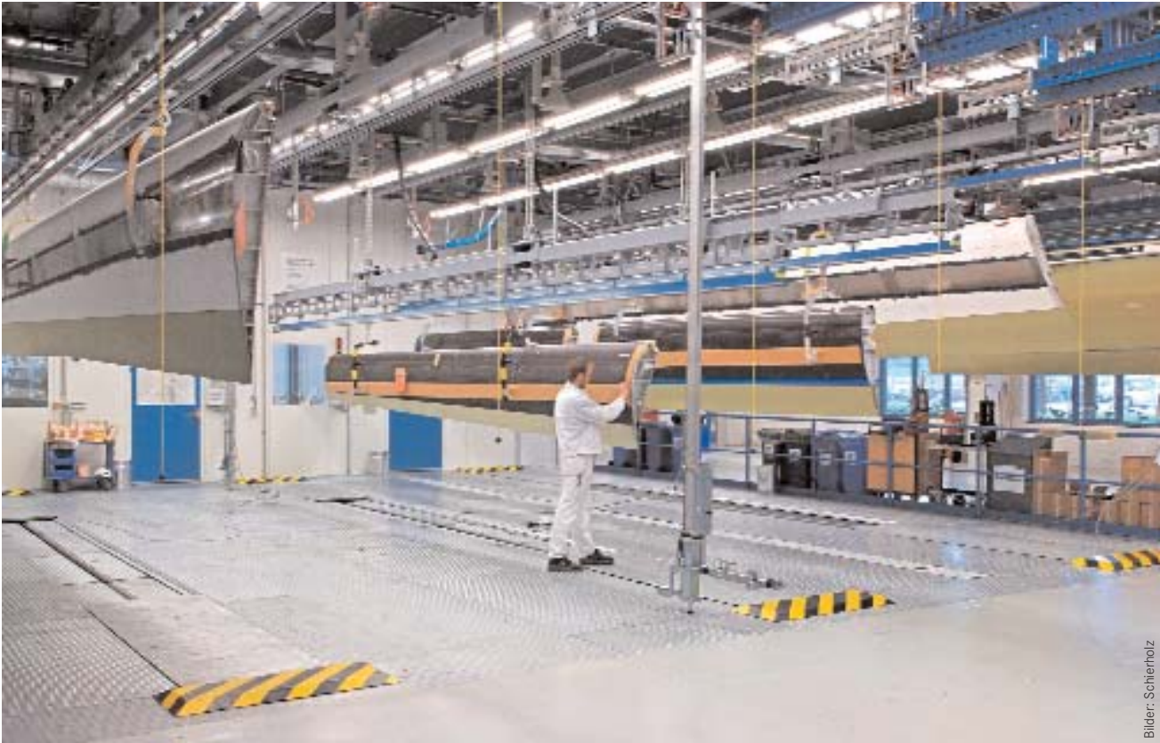
Während die Roboter mit den unterschiedlichen Teilegrößen kein Problem haben, sind die manuellen Arbeitsplätze aus ergonomischen Gründen mit Hub-/Senkstationen und verschließbaren Gruben versehen
