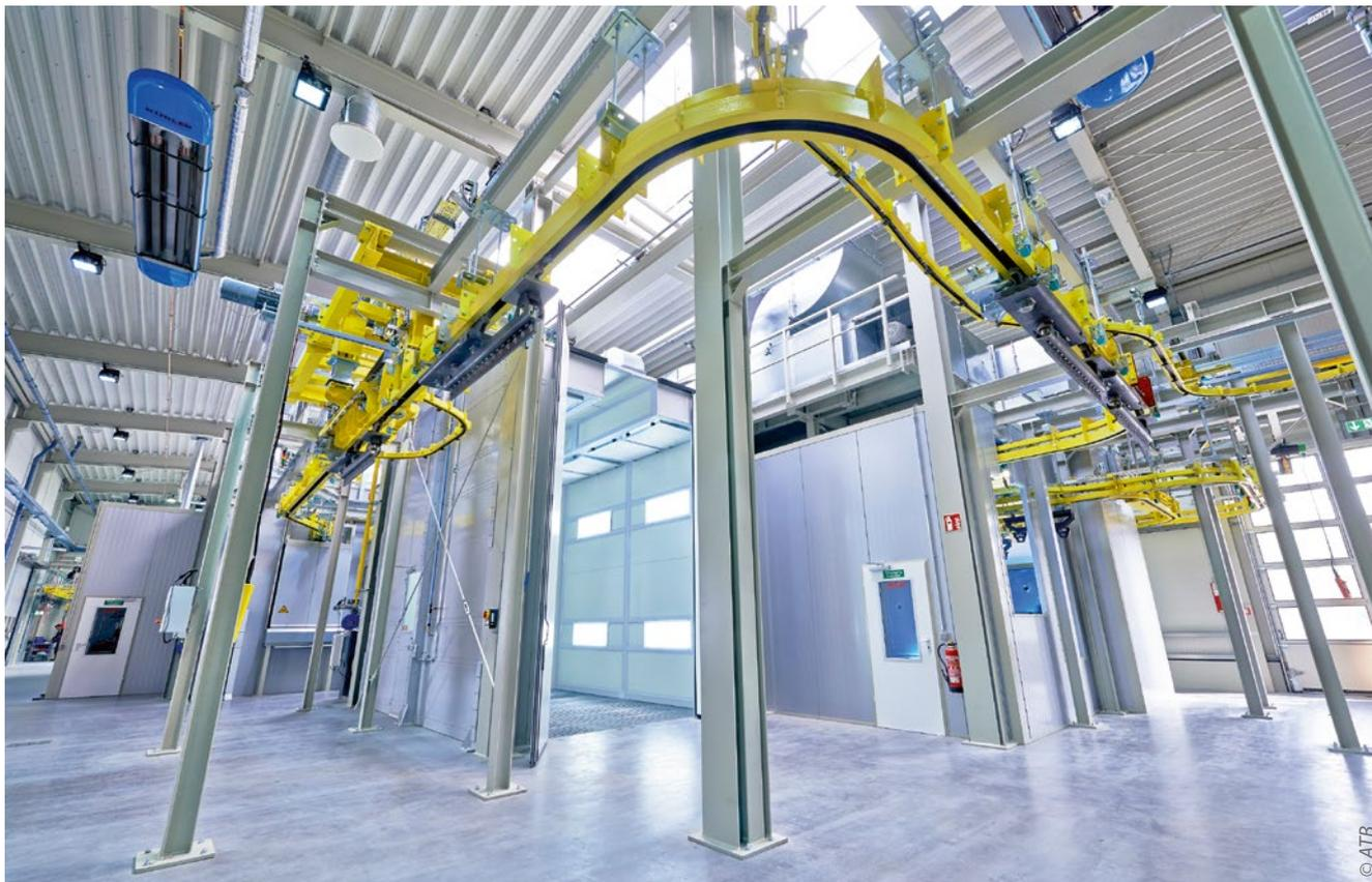
Der großzügige Auf- und Abnahmebereich schafft eine Voraussetzung für geordneten und zügigen Materialfluss. Im Hintergrund: die Lackierkabine für Großmotoren.
