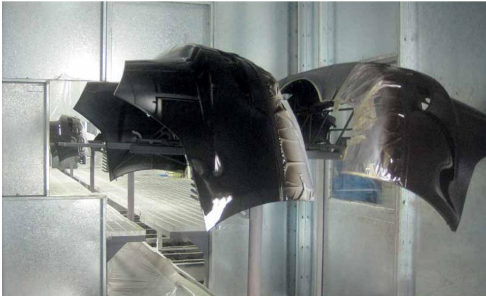
Der Warenträger ist mit Bumpern doppelt belegt und wird mit dem „P+F 100“-System in die Lackierkabine geschleust.
