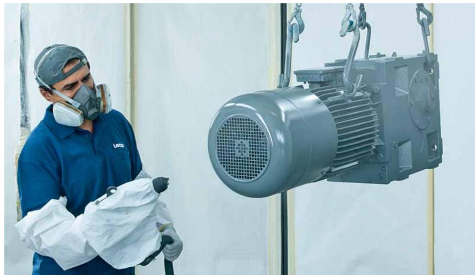
In der neuen Lackieranlage stehen jetzt fünf Standardfarben direkt zur Verfügung. Die Farbversorgung erfolgt über eine elektronisch geregelte 2K-Anlage.
