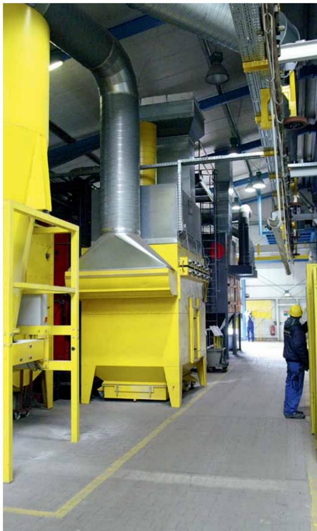
Die Anlage mit Zyklon-Pulverrückgewinnung und Nachfilter (li.) ist rund 70 m lang. ND-Coatings kann in 24 Stunden rund 350 Bauteile strahlen, reinigen, lackieren und trocknen. **Quelle: (zwei Fotos): Meeh**
