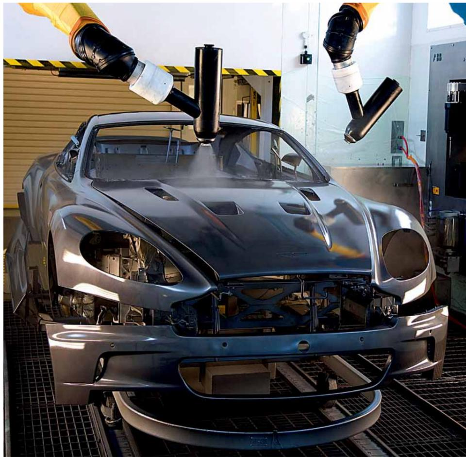
Für den Auftrag des Wasserbasislacks wird der „RB1000“-Zerstäuber in der „Cartridge Bell System“- (CBS-) Version eingesetzt, die eine Lackierung mit dem effektiven Direktaufprinzips ermöglicht. Darüber hinaus wird die unmittelbar am Zerstäuber befindliche Kartusche nur mit der für den Lackiervorgang notwendigen Farbmenge gefüllt, was eine optimale Nutzung des teuren Lackmaterials gewährleistet.
