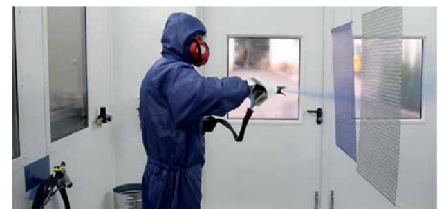
Für die Applikation stehen luftzerstäubende Verfahren im Hoch-, Mittel- und Niederdruck, AirCoat und Airless, luftzerstäubende Elektrostatik oder AirCoat-Elektrostatik zur Verfügung. Quelle: Thüma
