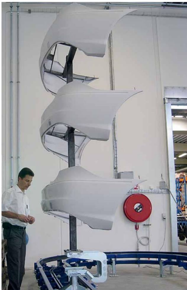
Der neue Bodenförderer ermöglicht Anwendern eine dreifache einseitige Belegung übereinander.
