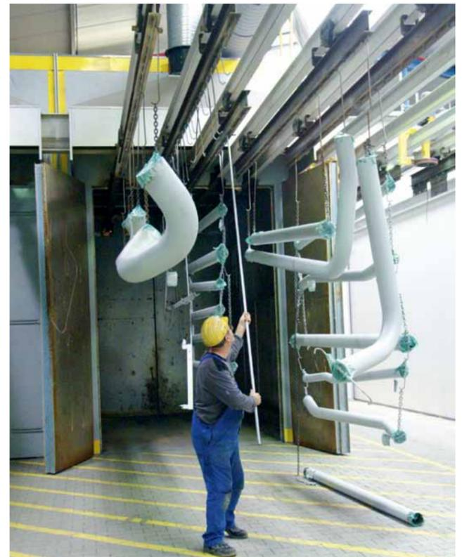
Die beiden Öfen sind jeweils mit fünf Förderschienen ausgestattet, die einzeln gesteuert werden können.
