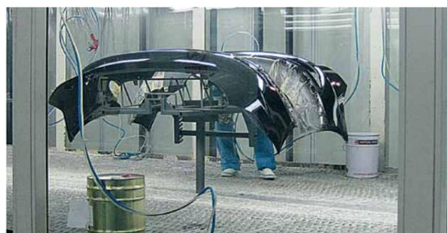
Speziell in der Kunststofflackierung kommen Bodenfördersysteme aufgrund ihrer Genauigkeit und Stabilität zum Einsatz.
