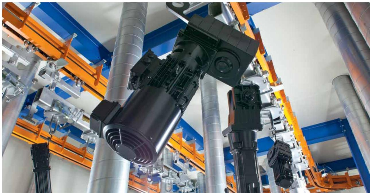
Mit dem Fördersystem lassen sich bis zu 2000 kg schwere zu lackierende bzw. lackierte Bauteile transportieren. Quelle (zwei Fotos): Lenze
